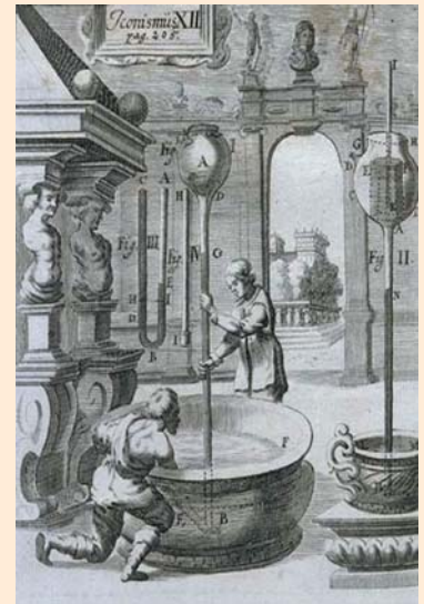
Experiment vom Typ nach Torricelli Gaspar Schott, Technica curiosa, sive, Mirabilia artis , Würzburg (1664)
